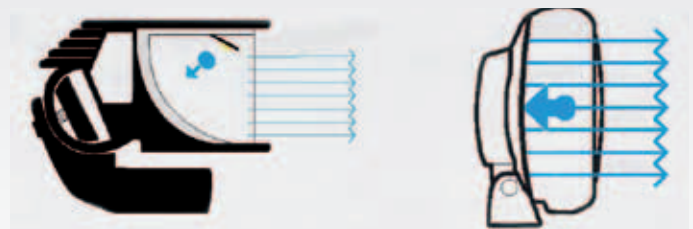
LED-Licht wird von Reflektoren gebündelt. Dadurch mehr gezielte Ausleuchtung bei weniger Energie.
