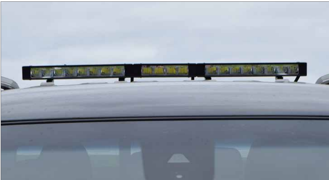
Fernscheinwerfer PIAA RF10 und RF18 gelb (Breitstrahler)/Light Bar RF10 and RF18 yellow (wide beam)
