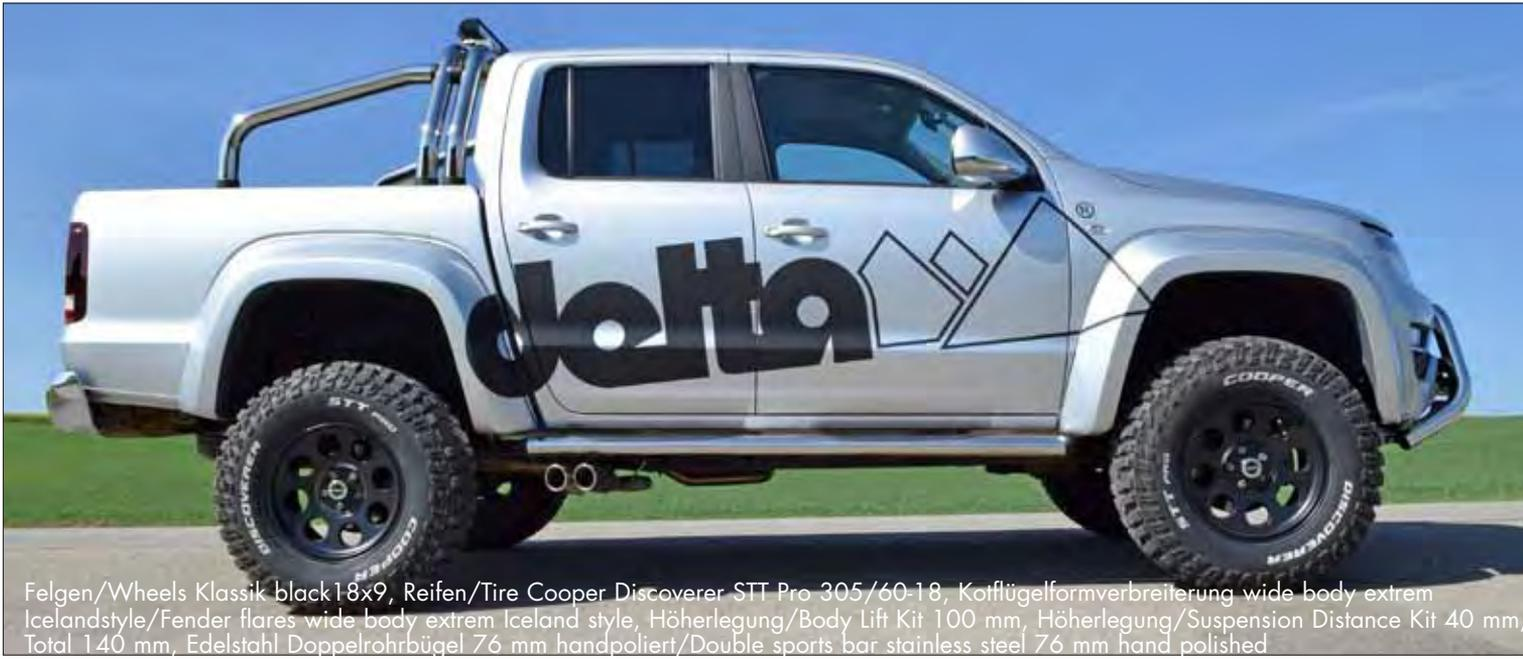
Felgen/Wheels Klassik black 18x9, Reifen/Tire Cooper Discoverer STT Pro 305/60-18, Kotflügelverbreiterung wide body extrem Icelandstyle/Fender flares wide body extrem Iceland style, Höherlegung/Body Lift Kit 100 mm, Höherlegung/Suspension Distance Kit 40 mm, Total 140 mm, Edelstahl Doppelrohrbügel 76 mm handpoliert/Double sports bar stainless steel 76 mm hand polished
