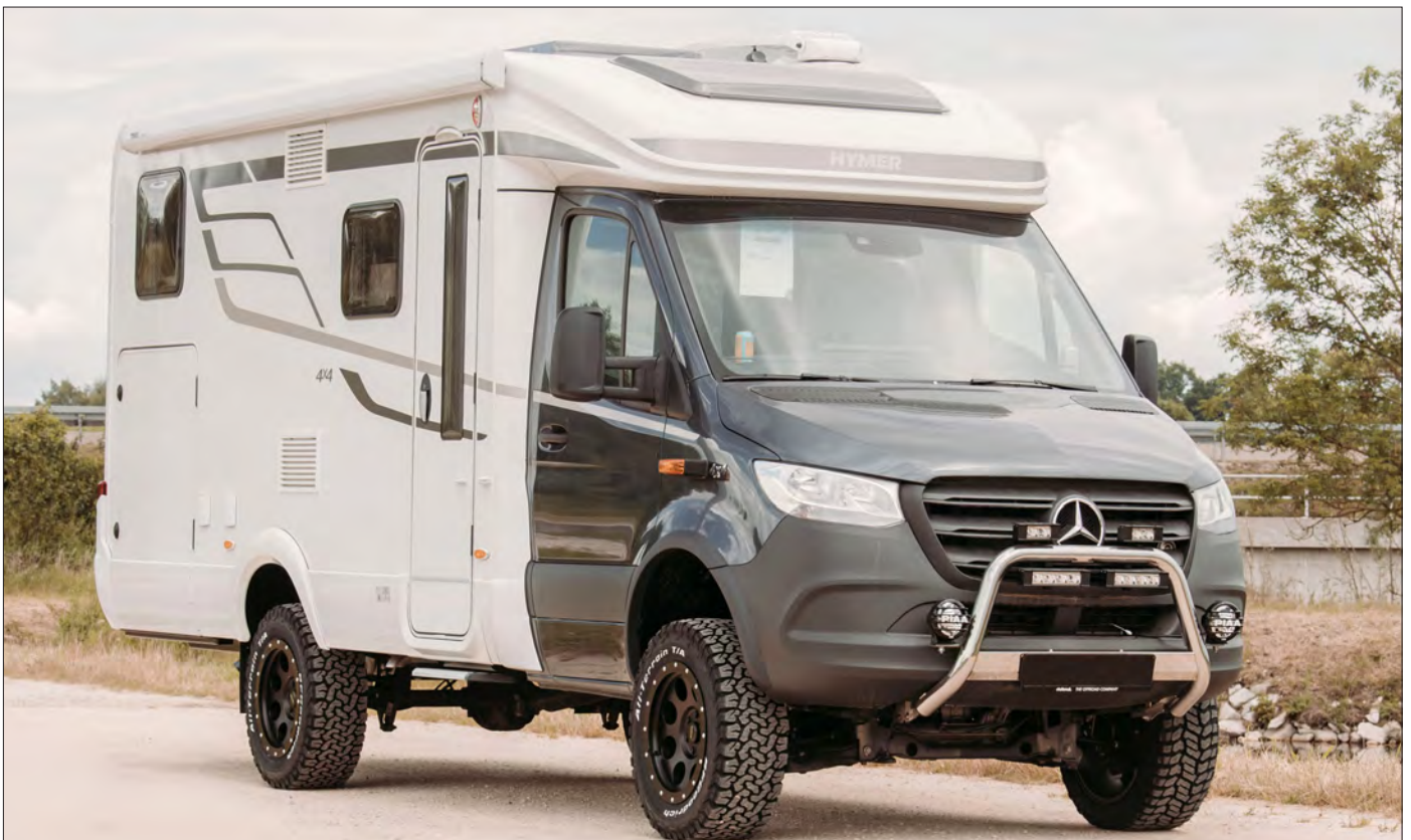
Felgen/Wheels Klassik_B schwarz/black 18x9 mit Reifen/Tires 285/60-18 BF Goodrich AT K02, Scheinwerfer PIAA LP550, EC Frontbügel Edelstahl/Front Bar polished tested after the EC Pedestrian Security Regulation, Fahrzeughöherlegung, Federndistanz-Satz mit Trailmaster-Stoßdämpfersatz +40 mm/Suspension distance kit with Trailmaster Shock absorber +40 mm, Radabdeckung Vorderachse +35 mm/Wheel cover front axle +35 mm.
